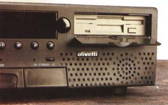
Particolare del floppy disk drive e del ricevitore ad infrarossi.
